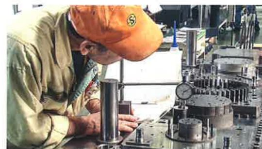
《金型整備 金型の調整を行っている様子》
